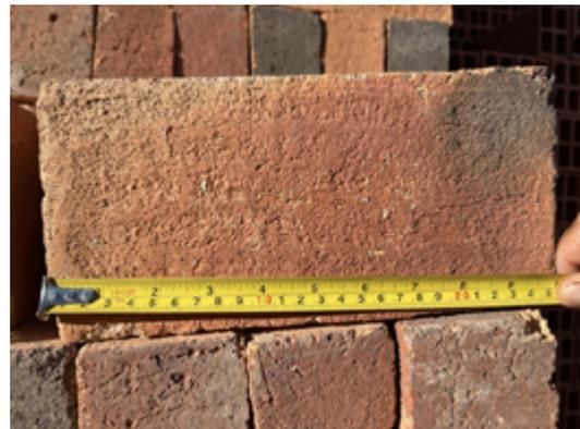
Para las pruebas se utilizan los equipos del laboratorio de construcciones de la facultad de Arquitectura de la Universidad de Cuenca, procediendo a codificar, pesar y rotura de los ladrillos artesanales en la prensa hidráulica para determinar el peso y la resistencia a la compresión del material, como se observa en las figuras 15 y 16.
