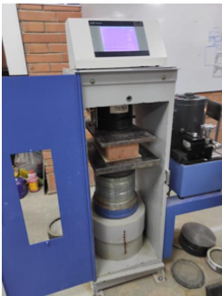
Como resultado, se determina que los ladrillos artesanales denominados “panelón”, de alta cocción tienen un peso promedio de 3121,34 gramos; y, una resistencia a la compresión promedio de 74,24 Kg/cm<sup>2</sup>, como se detalla en el cuadro de la Tabla 4:
