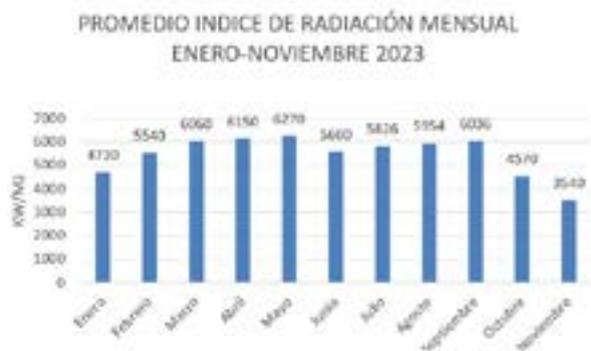
En referencia a la radiación solar promedio captada mensualmente, se puede deducir la cantidad de HSP que tiene cada mes, como se observa en la figura 7, teniendo como en referencia la radiación solar que llega en un  $m^2$  con una constante de 1,000 W. Estos datos servirán para calcular la proyección de los kW que genera el sistema fotovoltaico.
