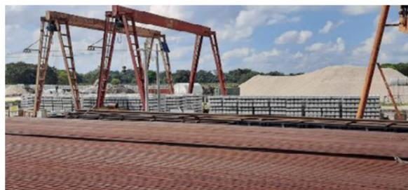
Las traviesas que se están fabricando para la rehabilitación del sistema miden 2,60 metros de largo, 30 cm de ancho y 25 cm de alto, como se muestra a continuación
