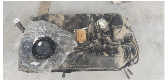
Depósito de combustible
